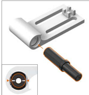
Lagerbolzen mit Markierung auf Mitte (Nullstellung) in das Flügelbandteil einschieben (DIN links/DIN rechts).
